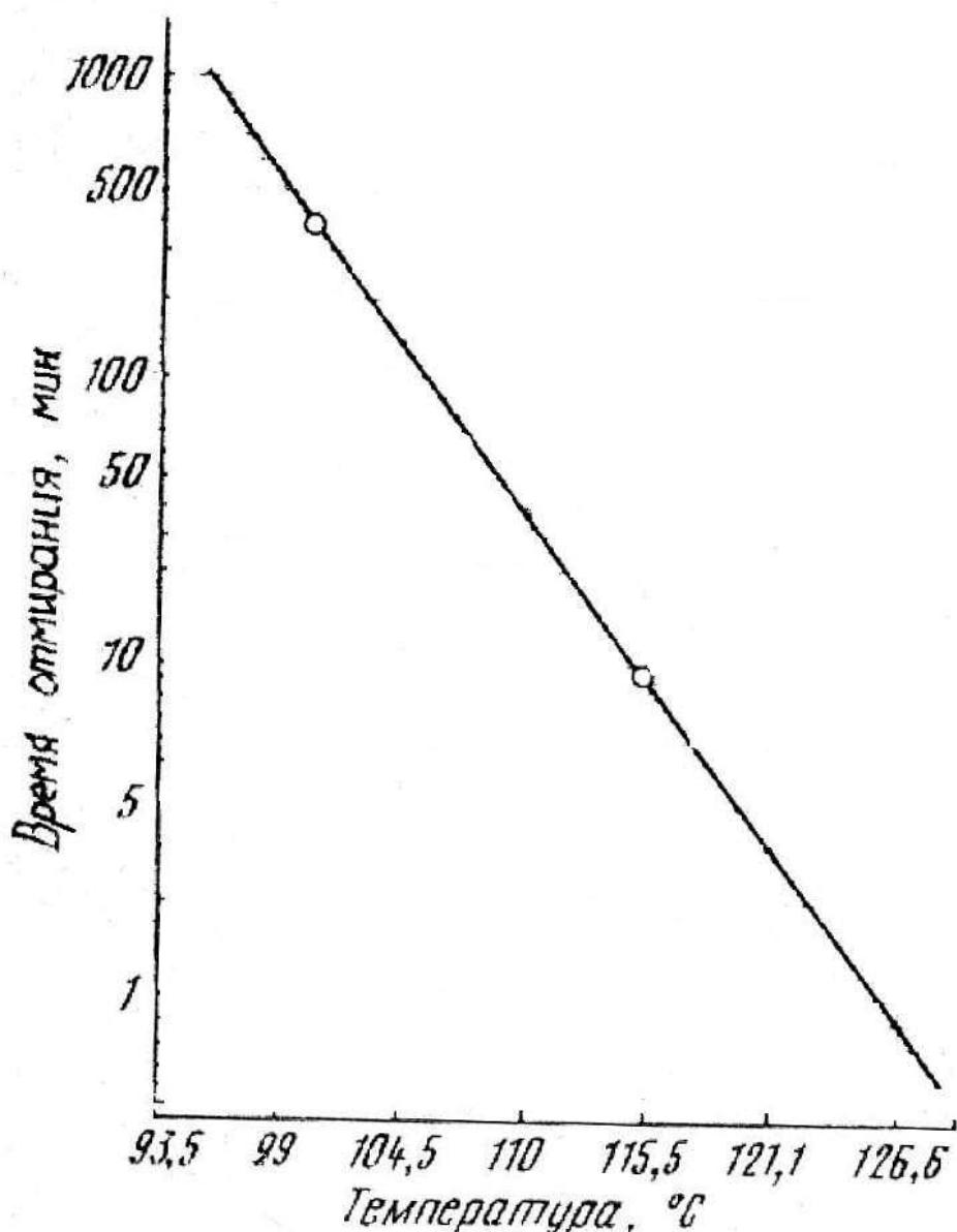
Рис. 1.10. Зависимость времени отмирания от температуры в полулогарифмических координатах
