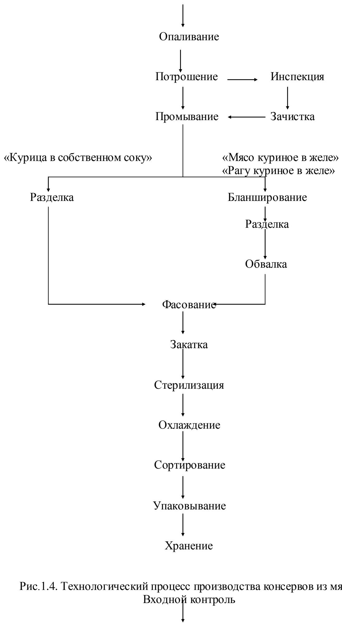
Рис.1.4. Технологический процесс производства консервов из мяса птицы
