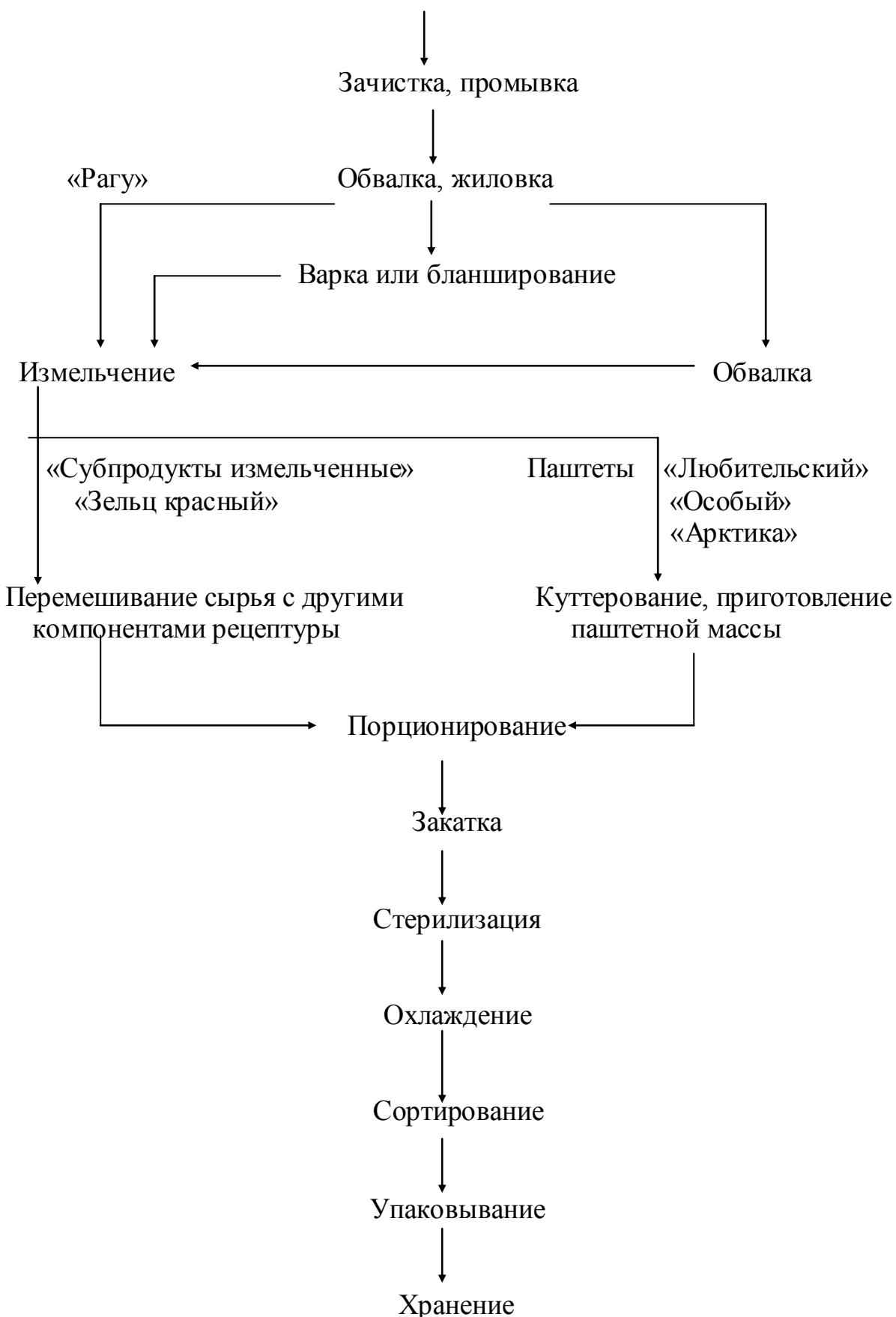
Рис. 1.3. Технологический процесс производства субпродуктовых консервов
