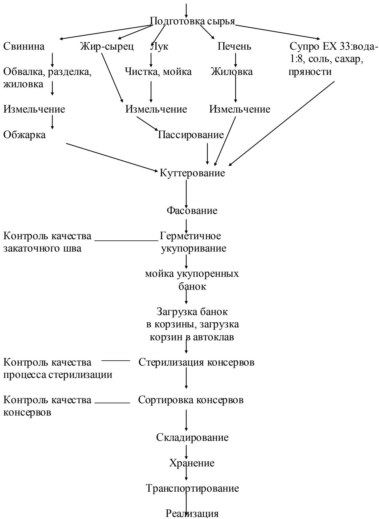
Рис. 1.8. Технологическая схема производства мясных консервов
