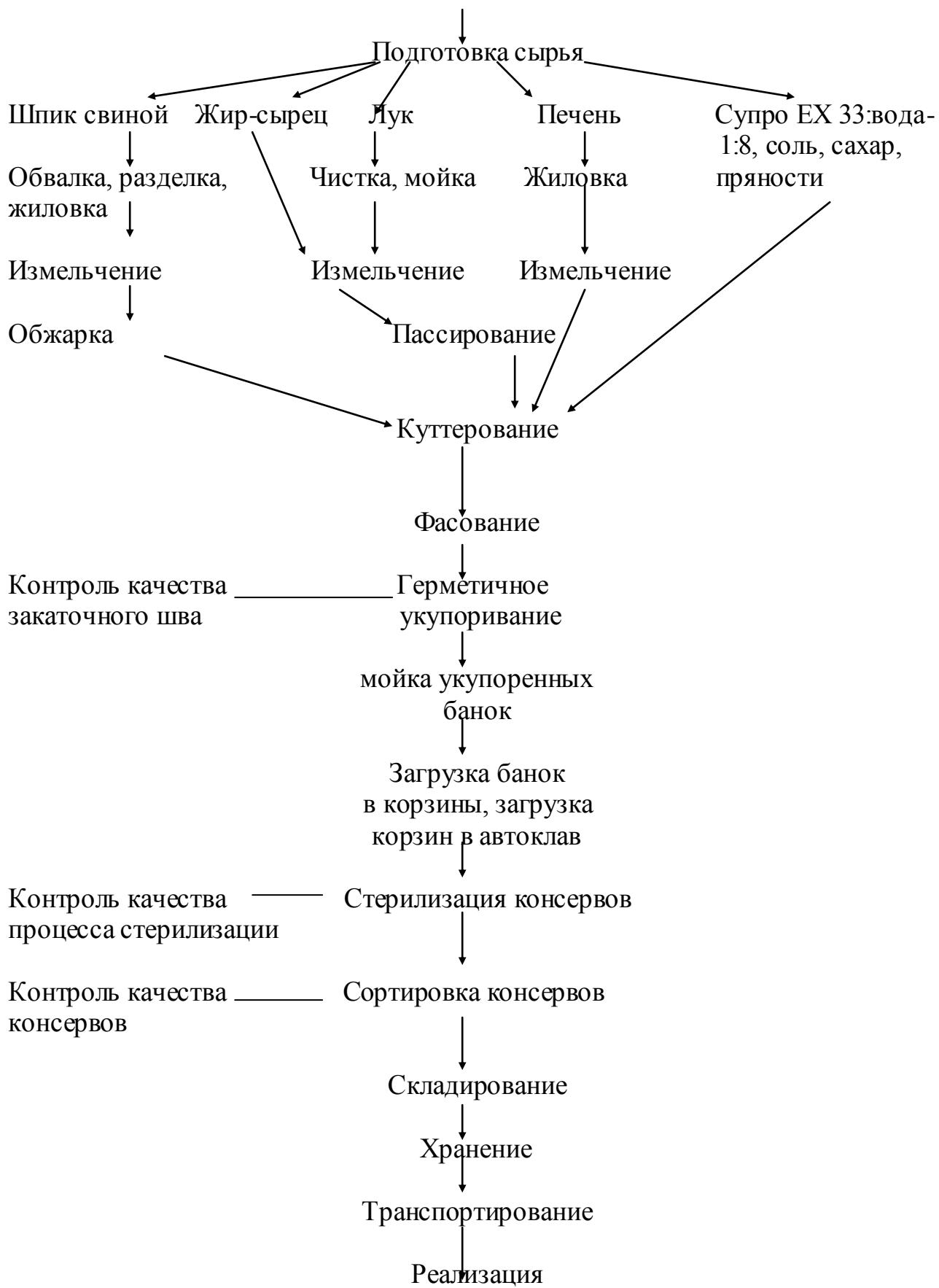
Рис. 1.7. Технологическая схема производства мясных консервов
