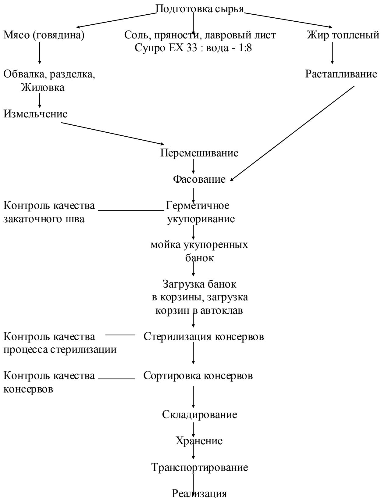
Рис. 1.5. Технологическая схема производства мясных консервов «Говядина тушеная троицкая»
