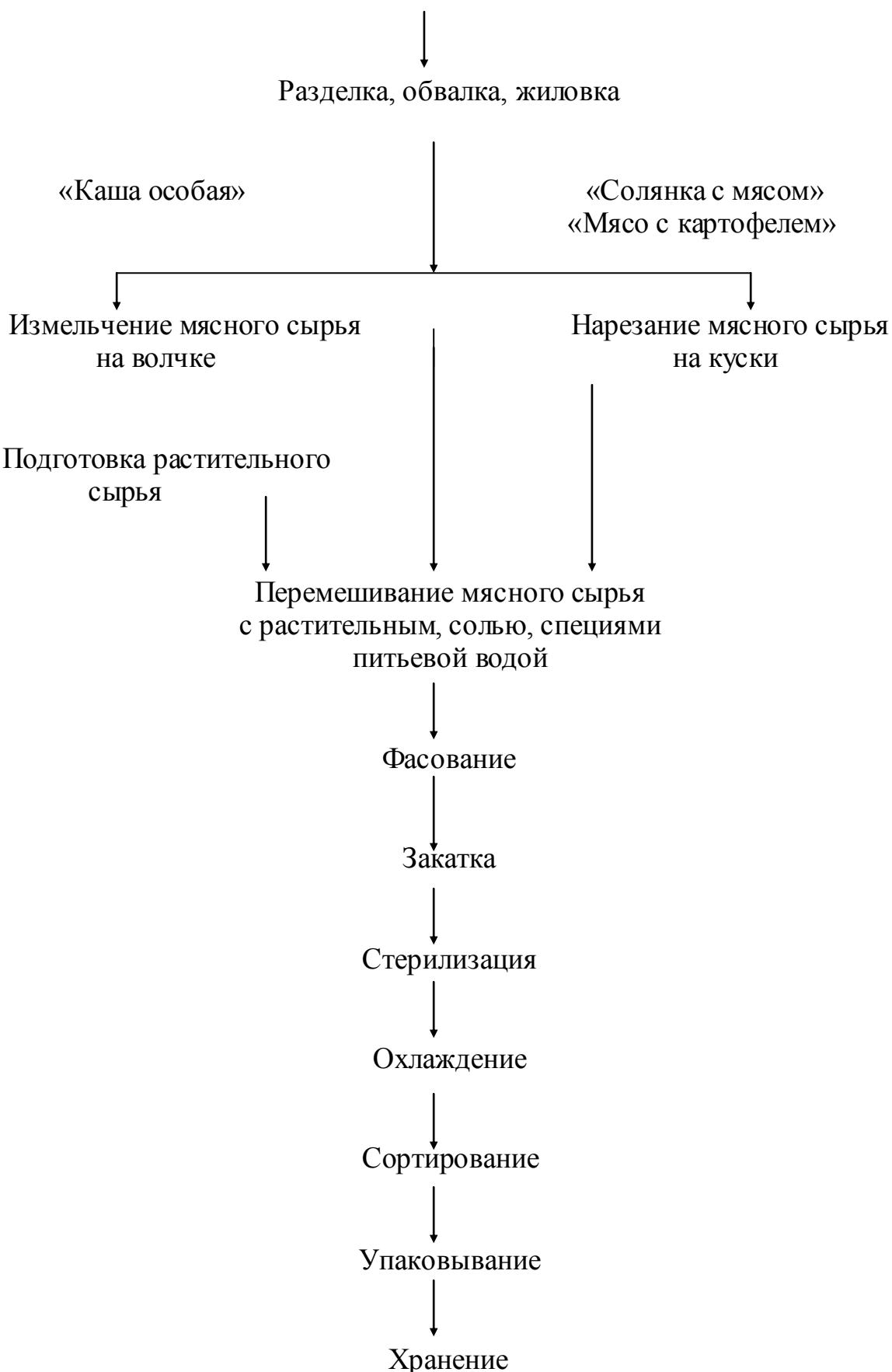
Рис.1.2. Технологический процесс производства мясо-растительных консервов
