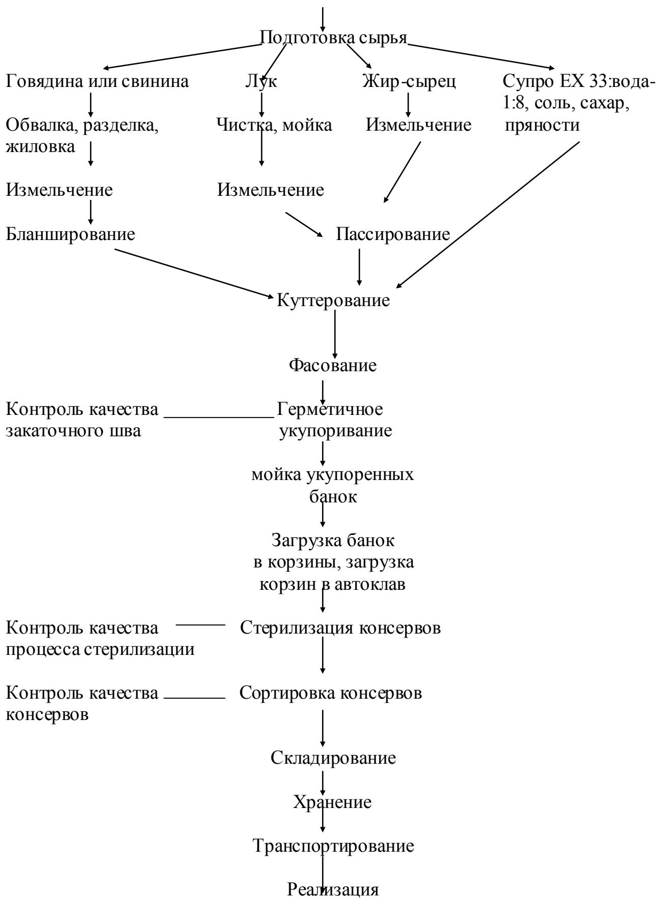
Рис. 1.6. Технологическая схема производства мясных консервов
