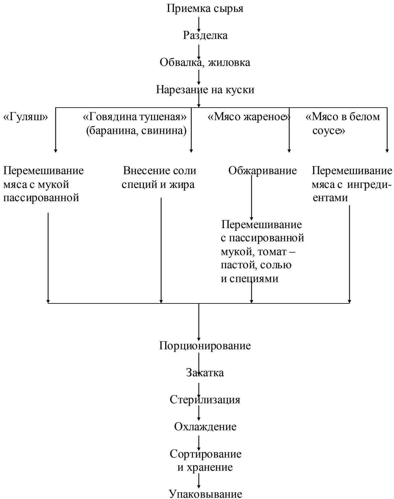
Рис.1.1. Технологический процесс производства натурально-кусковых консервов
