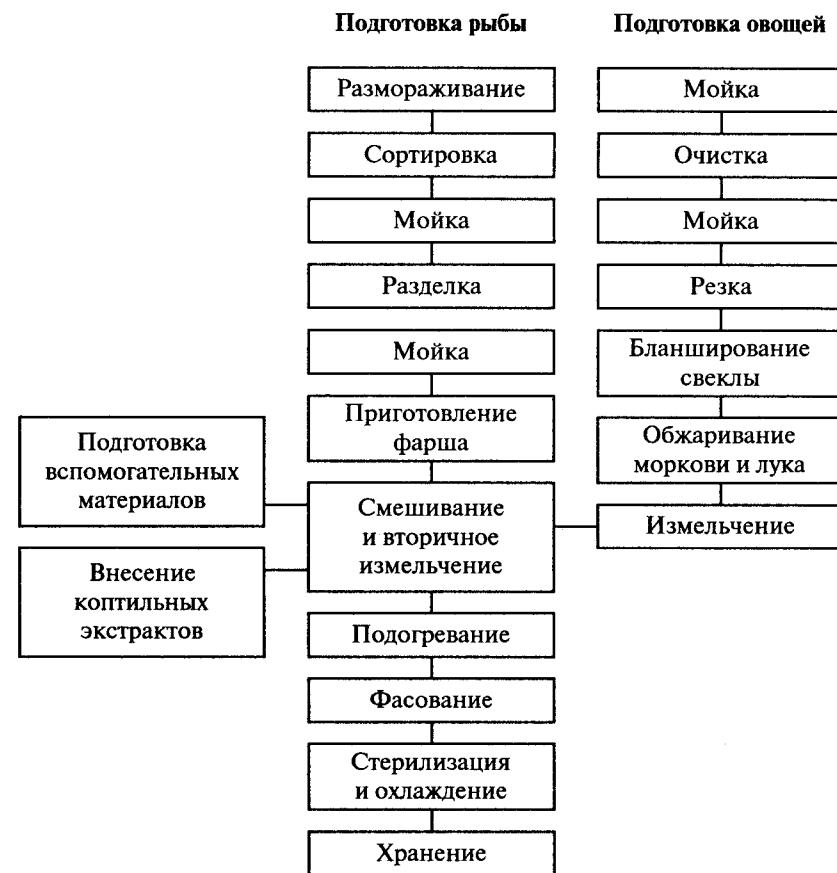
Рис. 36. Технологическая схема производства рыбоовощного паштета
